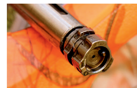
A cabeça do ferrolho possui seis trincos, cabeça envolvente e expulsor ativo.
