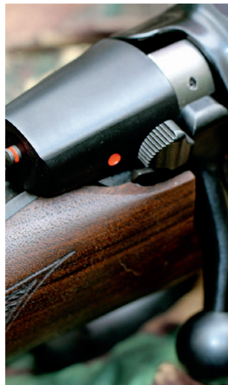
A patilha de segurança, bem localizada, e o manobrador do ferrolho, bem dimensionado.
