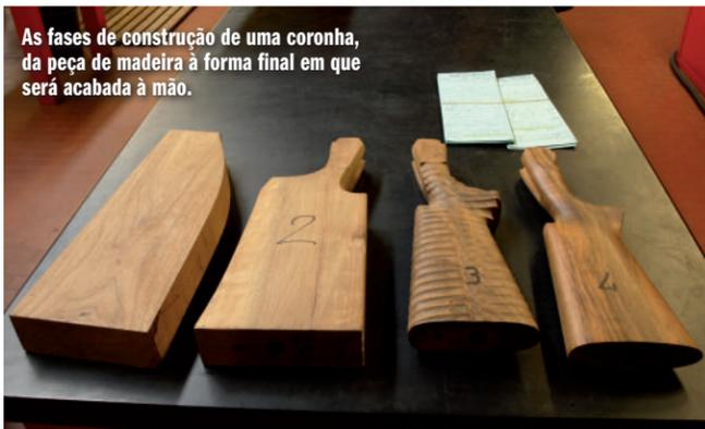
As fases de construção de uma coronha, da peça de madeira à forma final em que será acabada à mão.
