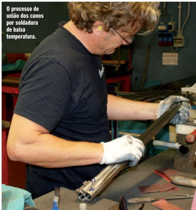
O processo de união dos canos por soldadura de baixa temperatura.
