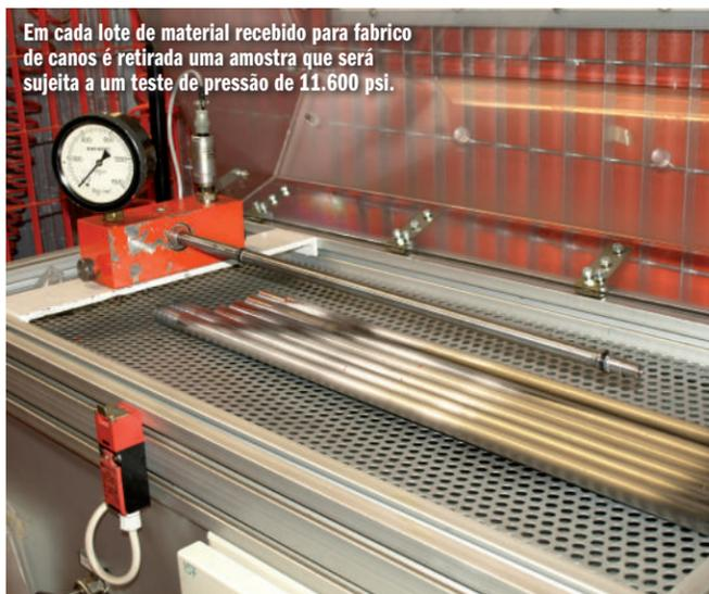
Em cada lote de material recebido para fabrico de canos é retirada uma amostra que será sujeita a um teste de pressão de 11.600 psi.
