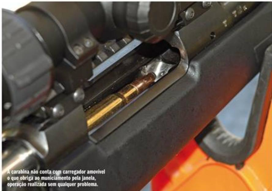
A carabina não conta com carregador amovível o que obriga ao munição pela janela, operação realizada sem qualquer problema.
